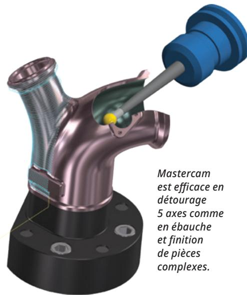
*Mastercam est efficace en détourage 5 axes comme en ébauche et finition de pièces complexes.*
